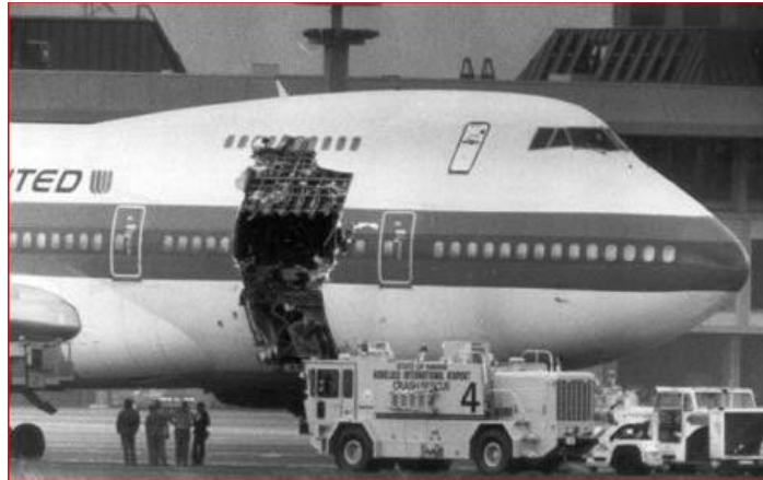
Şekil 2.3. United Havayollarının 811 sayılı seferindeki kaza sonrası uçağın hasarı [28]
