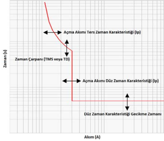
Şekil 3.2. Aşırı akım röle parametrelerinin ters ve düz zaman karakteristiğine etkisi
