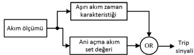
Şekil 1.3. Aşırı akım rölesi blok diyagramı
