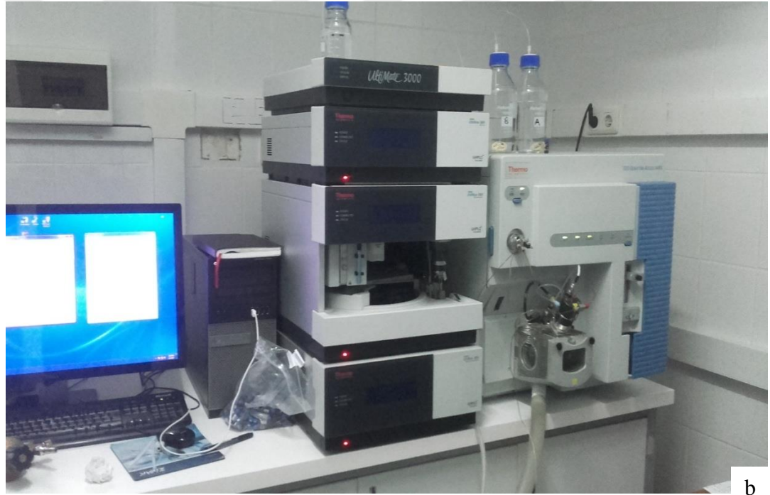
Şekil 2.11. LC-MSMS cihazı a) örnek yerleştirme b) cihaz görünümü
