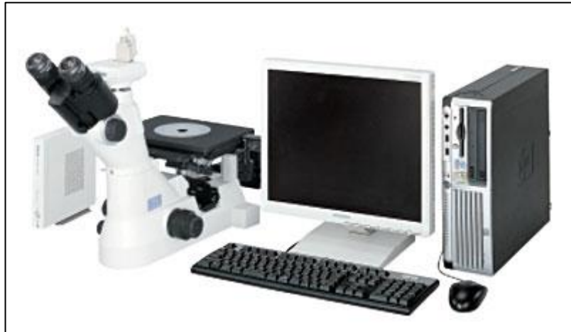
Şekil 2.8. Nikon MA100 optik mikroskop cihazı (URL-6)
