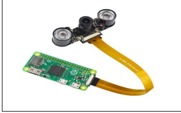
Şekil 3.1. Tez kapsamında donanım olarak kullanılan Raspberry Pi Zero W ve kızılötesi ışık destekli kamera modülü [59]
