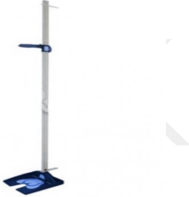
Resim 1. Boy uzunluğu ölçümü amacıyla kullanılan Seca marka boy ölçer.
