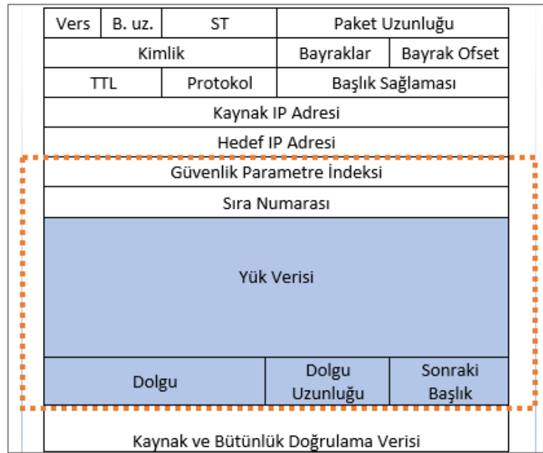
Şekil 1.6. İletim Modunda ESP Protokolünün Kullanımı
