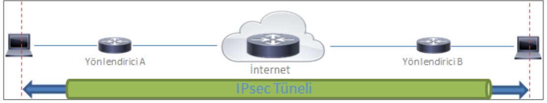
Şekil 1.5. İletim Modunda IPsec Protokolü
