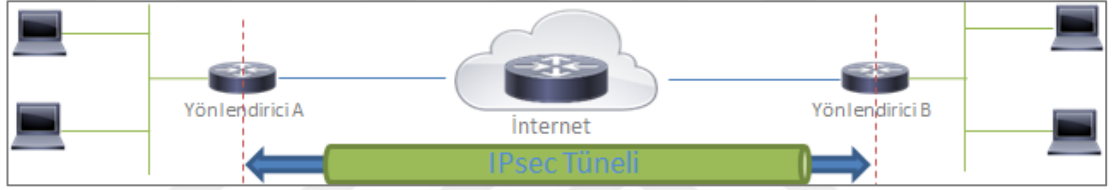
Şekil 1.8. Tünel Modunda IPsec Protokolü
