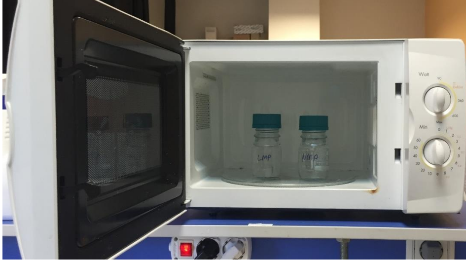
Şekil 3. 7. Mikrodalga fırında çözdürülen NMP ve LMP agarozlar
