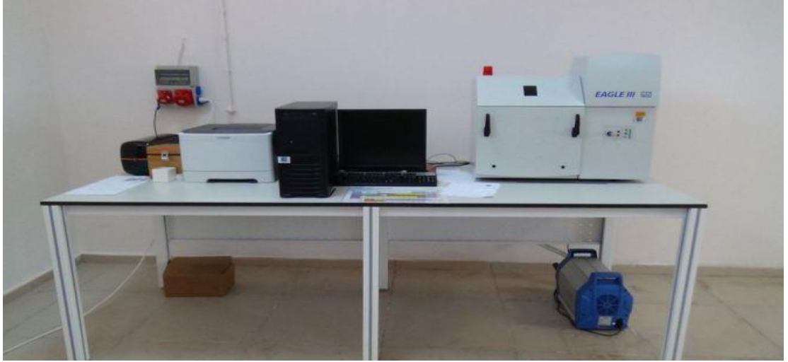
Şekil 2.19. Deneysel ölçümler için kullanılan XRF Spektrometresi [89]
