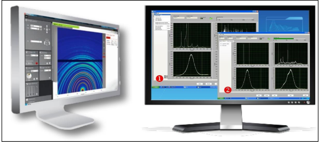
Şekil 2.11. Eş zamanlı ölçülen SAXS ve WAXS desenleri (Sağ: Hecus System3 cihazının yazılımı ve Sol: Anton Paar SAXSpace cihazının yazılımı) [76]
