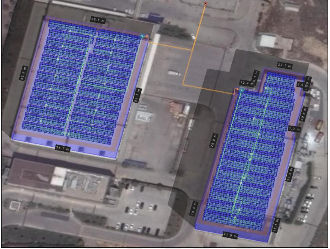
Şekil 3.5. Panel sistemleri yerleşim görünümü
