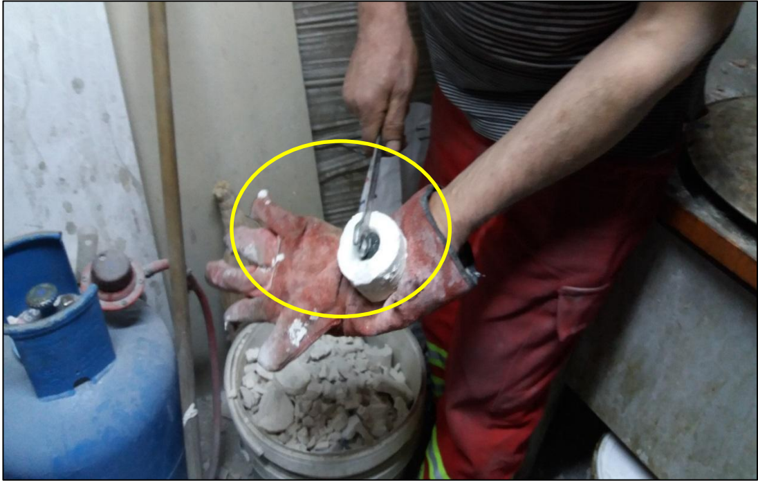
Şekil 1.5. Metal kronunun rövetmandan çıkarılması
