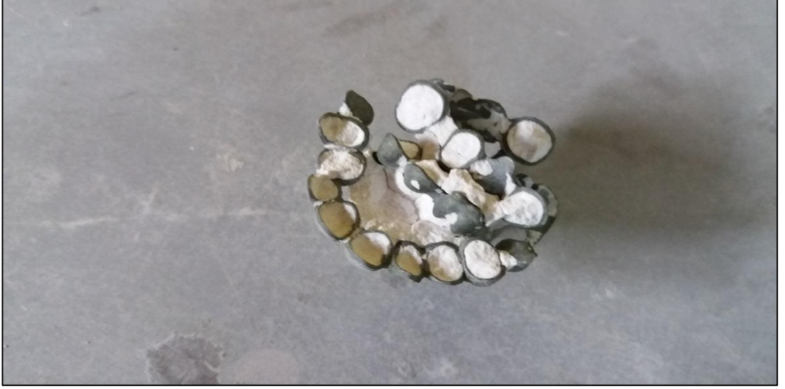
Şekil 1.6. Rövetmandan çıkan ham (işlenmemiş) protezler
