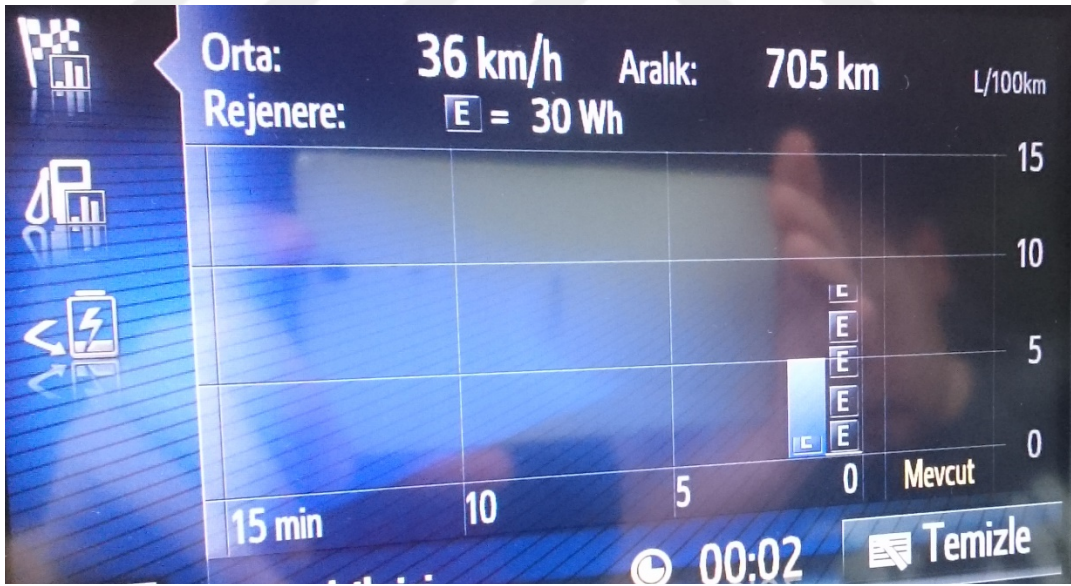
Şekil 4.6. Yakıt tüketimi ve rejeneratif frenleme bilgi ekranı
