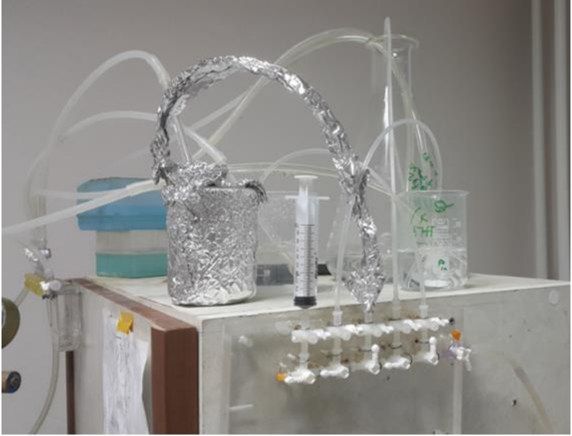
Resim 3.6: Yama kenetleme deneylerinde kullanılan perfüzyon sisteminin fotoğrafı. Beherlerde standart yBOS, içerisinde serotonin çözülmüş olan yBOS ve içerisinde 8-OHDPAT çözülmüş olan yBOS bulunmaktadır. 8-OHDPAT ışıktan etkilendiği için bulunduğu beher ve bağlı bulunan boru sistemi alüminyum folyo ile kaplanmıştır. Beherde bulunan solüsyonlar sürekli olarak oksijenlendirilmiştir.
