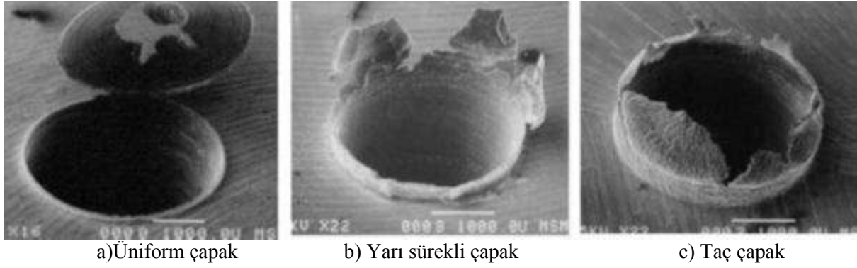
Şekil 1.16. AISI 4118 malzemenin delinmesi sonrası oluşan çapak tiplerinin sınıflandırılması
