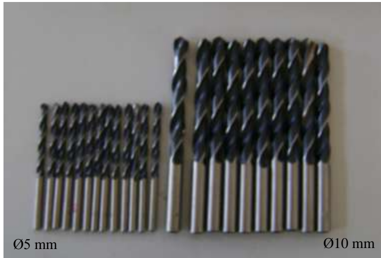
Şekil 2.2. Deneylerde kullanılan matkap uçları
