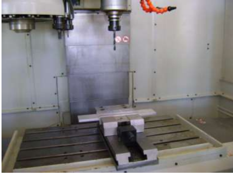
Şekil 2.1. Deney numunesinin dik işleme merkezli CNC freze tezgahına bağlanması
