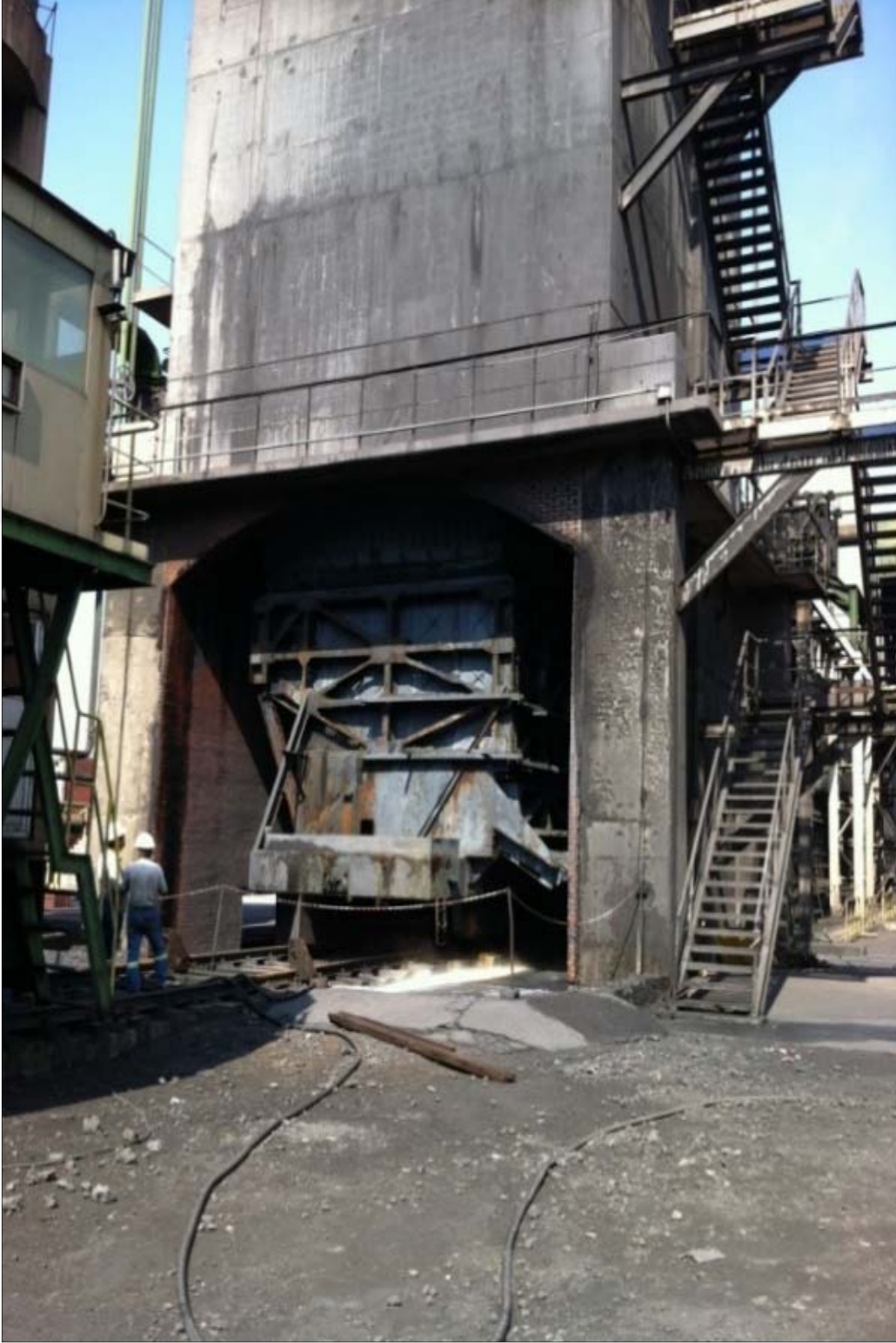
Şekil 1.13. Kok Bataryaları Yaş Söndürme Taşıyıcı Arabası
