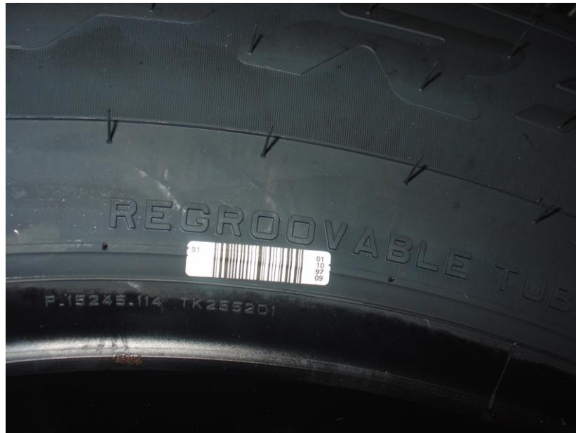
Şekil 3.7.Lastiğin topuk bölgesi üzerindeki barkod etiketi
