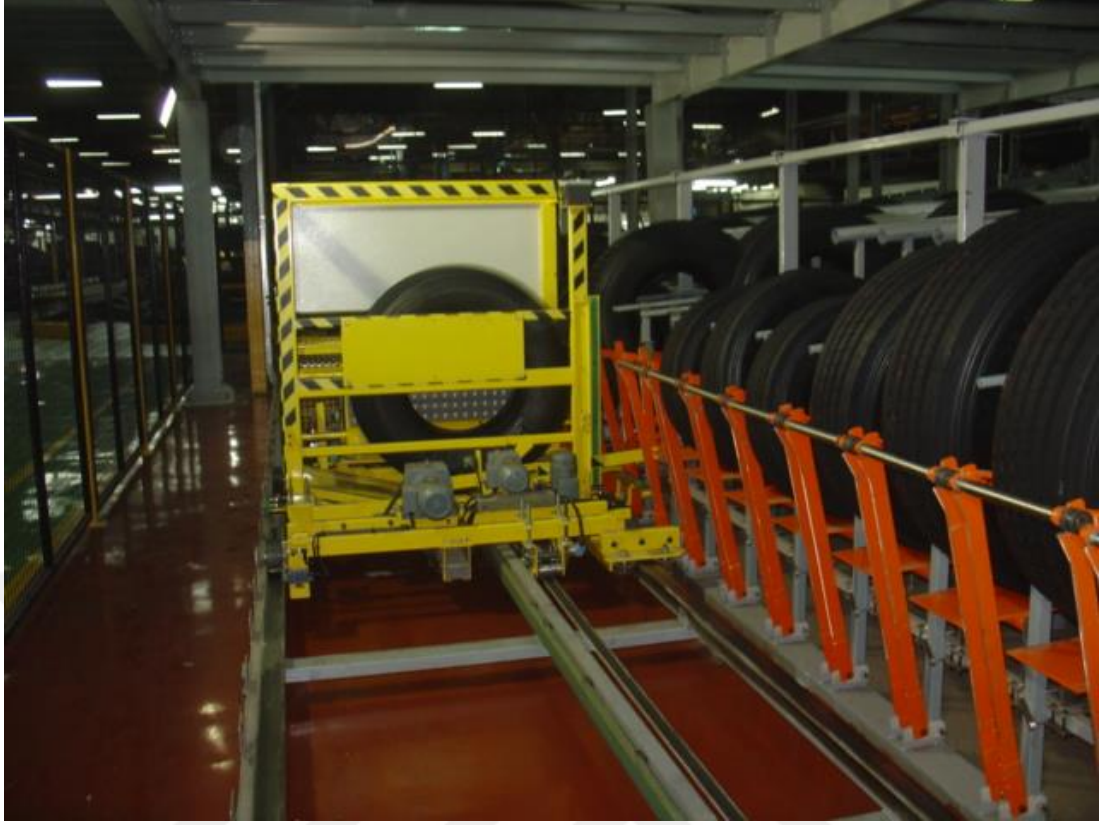
Şekil 3.25. Stok alanı çıkışı robotun kanaldan lastiği üzerine alması
