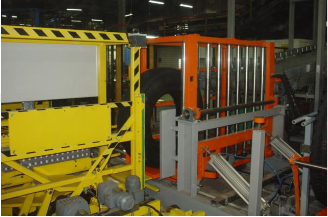
Şekil 3.26. Stok alanı çıkışı robotun lastiği çevirici gruba vermesi
