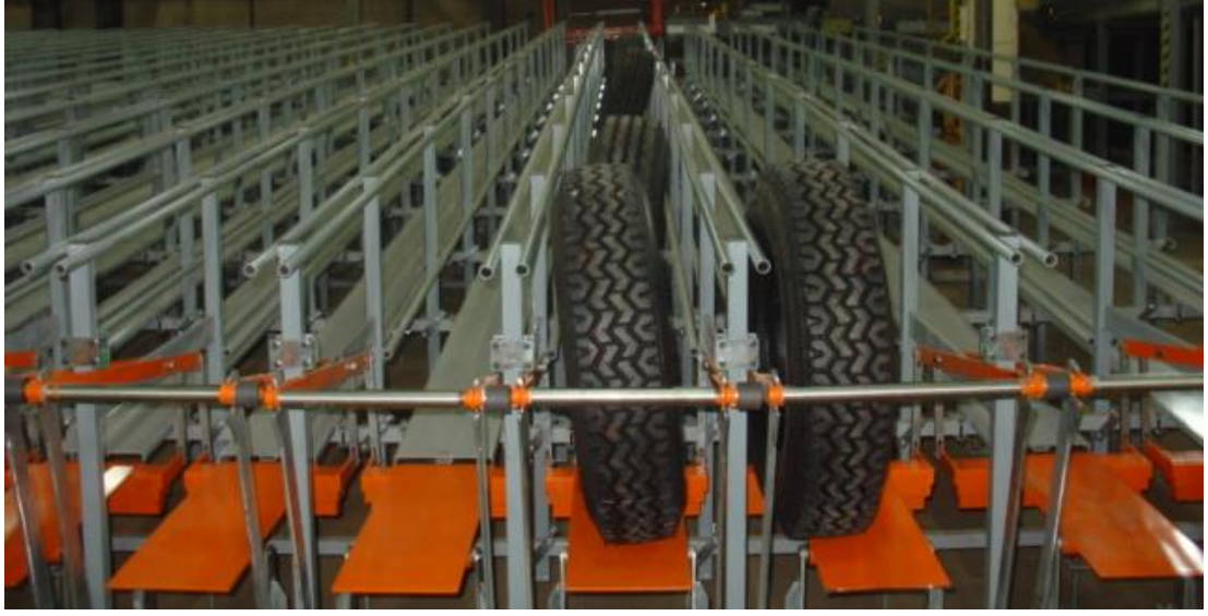
Şekil 3.27. Kontrol makinaları öncesi lastik tasnifleme alanı kanalları
