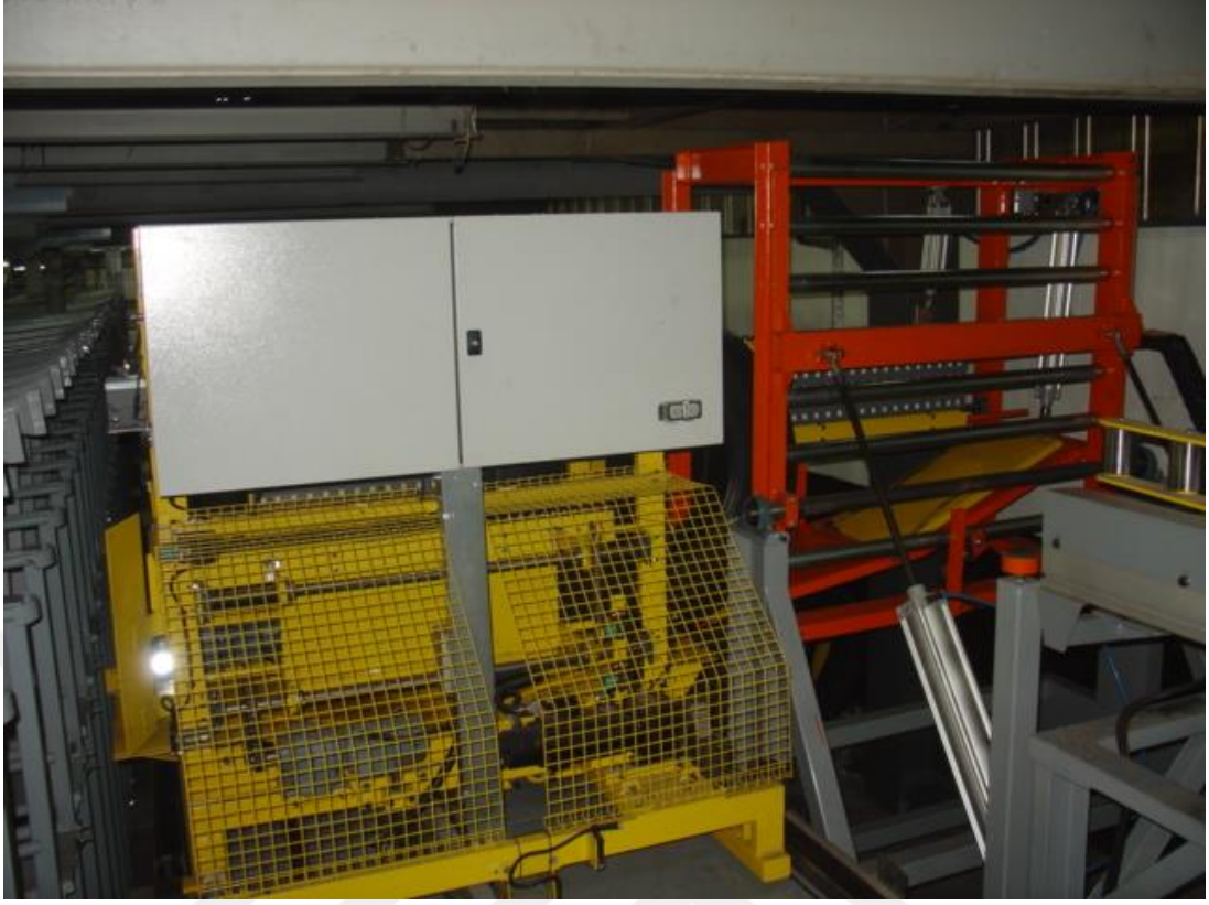
Şekil 3.21. Lastik çevirici grubu ve lastiğin robota transferi
