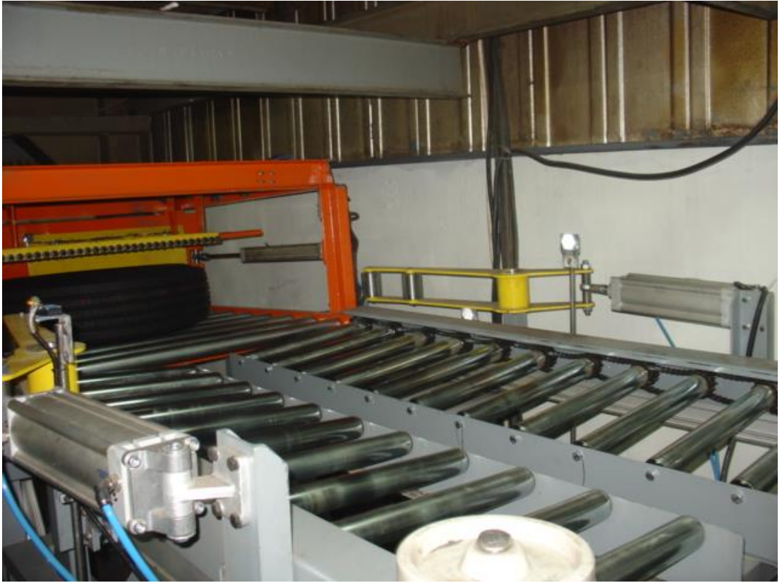
Şekil 3.19. Stok alanı öncesi lastik merkezleme ve döndürme sehpası
