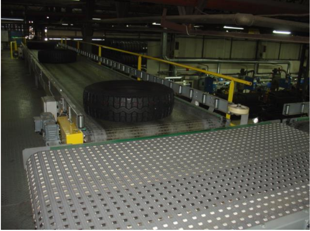
Şekil 3.39. "T" bağlantı noktasında TRT tip modüller konveyör kullanımı
