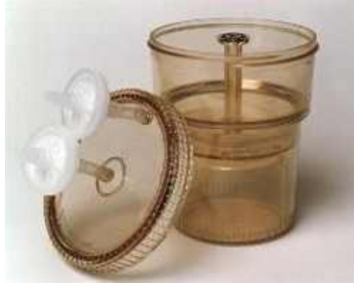
Şekil 1.2 Geçici daldırma sistem biyoreaktörün şematik görünümü
