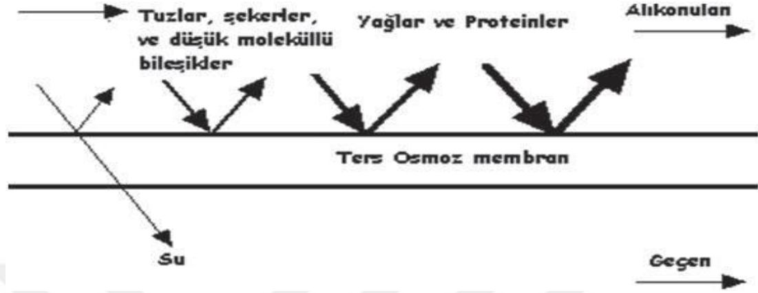
Şekil 1.9. Ters osmoz (RO/TO) membranlar (Aslan ve diğ., 2016)
