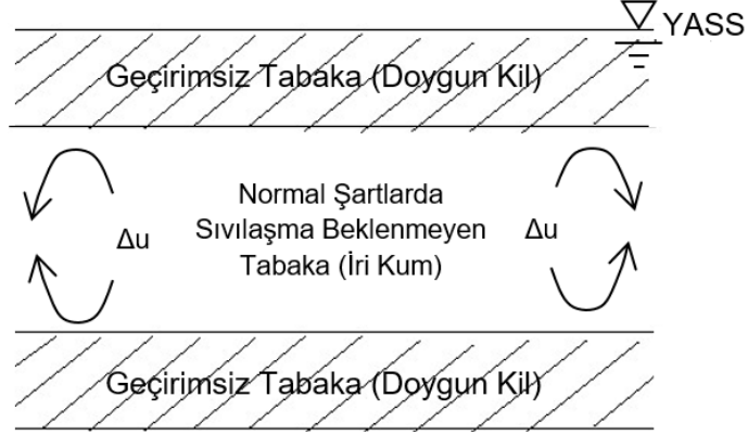
Şekil 1.3. Sıvılaşma potansiyelinin belirlenmesinde tabaka koşullarının etkisinin gösterimi
