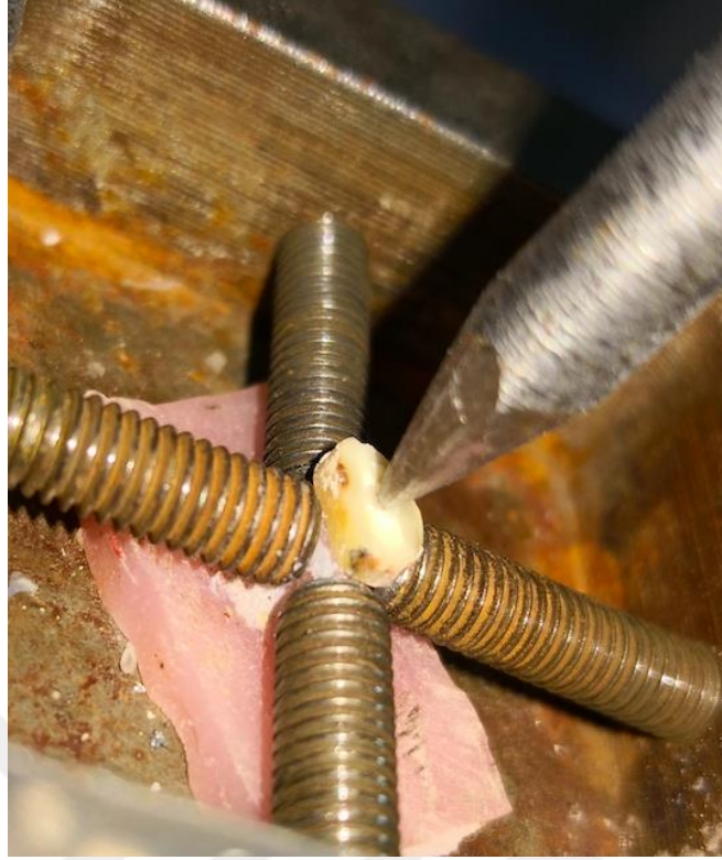
Resim 3.25. İtme bağlantı dayanımı testinin uygulanması
