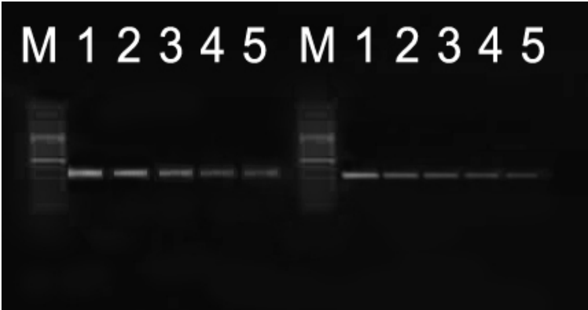
Şekil 4.8. FTS içindeki B.abortus 'un 10 katlı sulandırmalarından 2 farklı yöntemle elde edilen 337 bp DNA bantları
