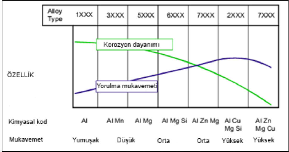
Şekil 1.5. Alaşım elementinin alüminyumun korozyon dayanımı ve yorulma mukavemetine etkisi (Ünel, 2016)
