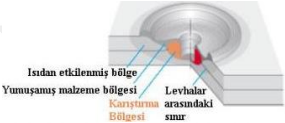
Şekil 3.4. FSSW yöntemi ile birleştirilmiş alüminyum ile çelik levha kesit görüntüsü (Chen ve diğ., 2012)
