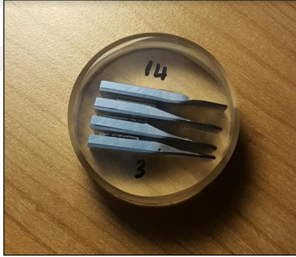
Şekil 4.7. SEM ve optik mikroskop analizleri için hazırlanmış olan T14, T9, T5 ve T3 numuneleri
