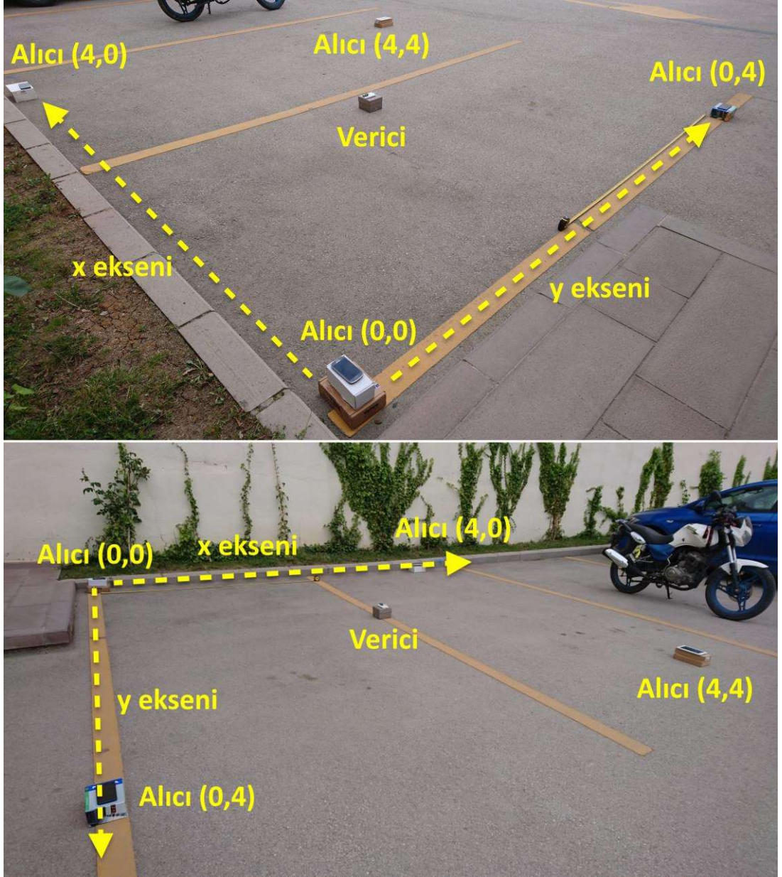
Şekil 3.25. 4 m x 4 m konum tespiti ölçüm alanının koordinat düzleminde gösterimi
