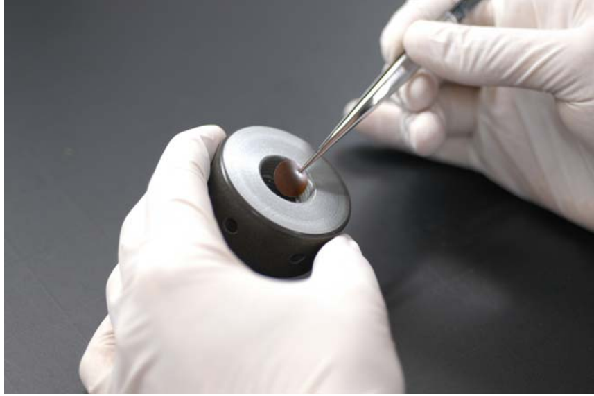
Şekil 3.4. Kırılıcı diskin başlık içine yerleştirilmesi (orijinal)
