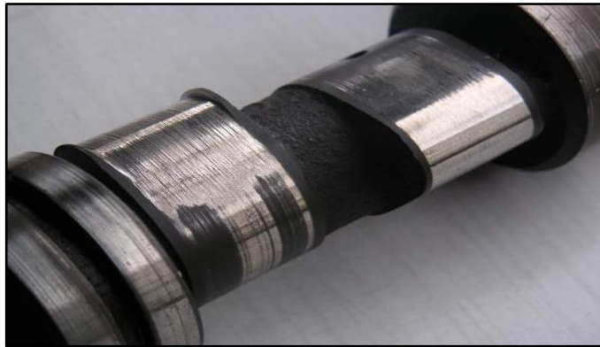
Şekil 3.2. Adhezif aşınmaya uğramış kam mili [60]
