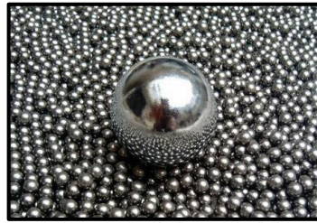
Şekil 2.1. Bilyalı dövme işleminin ana maddesi “Bilya” [37]
