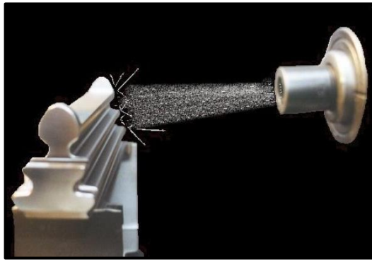
Şekil 2.3. Bilyalı dövme işlemi [43]
