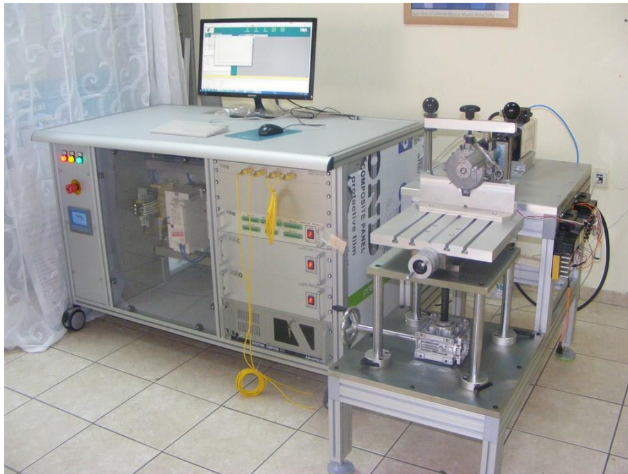
Şekil 4.7. Motor test sistemi
