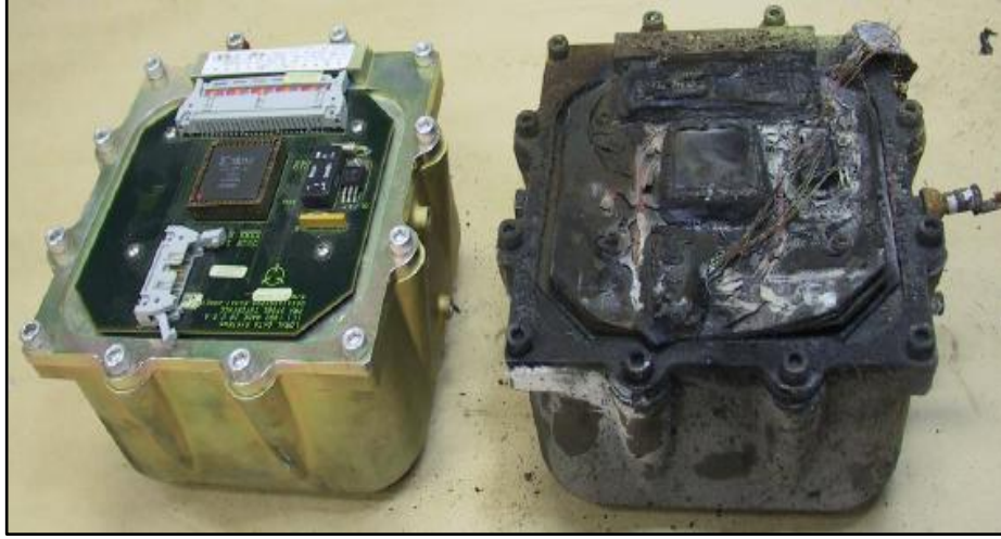
Şekil 2.5. Yangında hasar görmüş bir koruyucu muhafazanın sağlamı ile karşılaştırılması [34]
