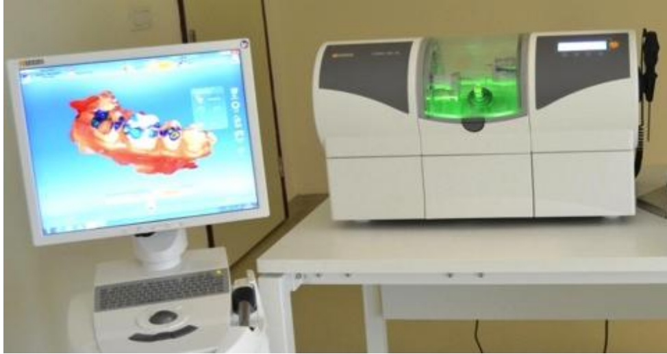
Resim 3. 7. CEREC AC Omnicam ağız içi kamera ve CEREC inLab MC XL frezeleme ünitesi
