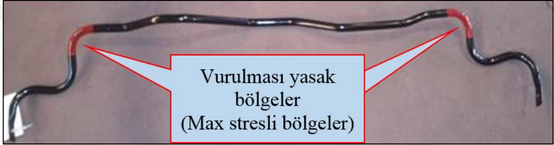
Şekil 3.8. Dođrultmada vurulmaması gereken bölgeler [6]
