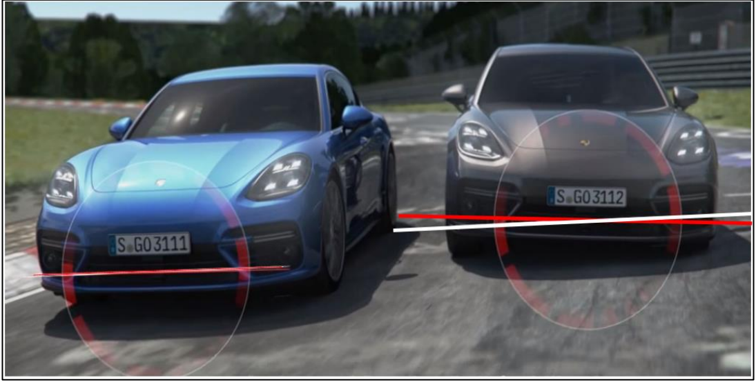
Şekil 1.3. Aktif ve pasif denge çubuklu araçların görsel savrulma miktarları, soldaki araçta aktif denge çubuğu; sağdaki araçta ise pasif denge çubuğu yer almaktadır [5]
