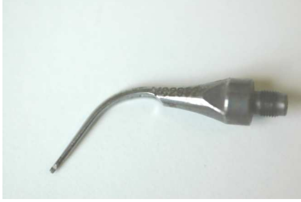
Resim 3.4. Modifiye edilerek keskinleştirilen ultrasonik uç
