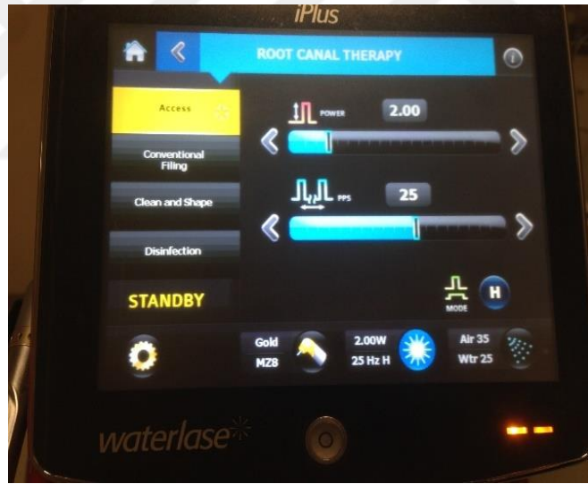
Resim 3.8. Kullanılan Er,Cr:YSGG lazer parametreleri
