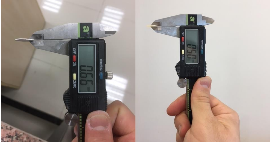
Resim 3-11: MZS örneklerin sinterizasyon öncesi ve sonrası kalınlıkları
