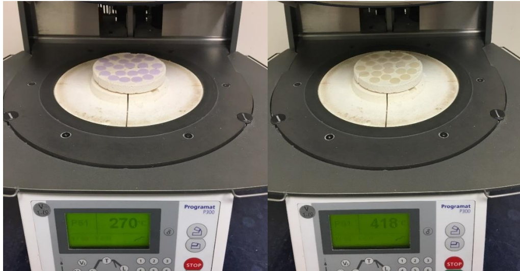
Resim 3-6: Kristalizasyon işlemi öncesi ve sonrası LDS örnekler
