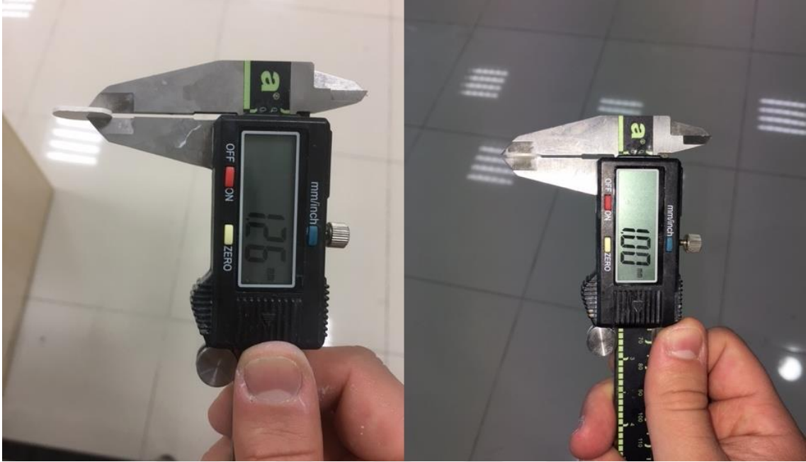
Resim 3-9: ZKS örneklerin sinterizasyon öncesi ve sonrası kalınlıkları
