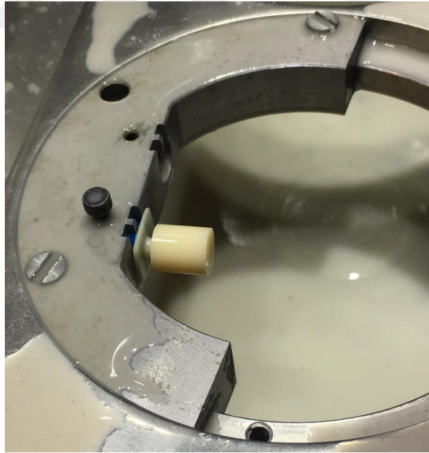
Resim 3-2: Blokların silindirik hale getirilmesi
