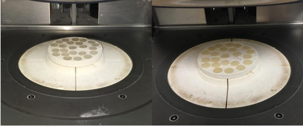
Resim 3-7: Kristalizasyon öncesi ve sonrası ZDS örnekler
