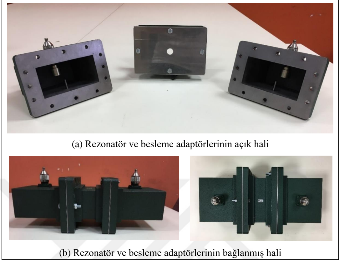
Şekil 4.4. Açıklık uyarımlı rezonatör ve besleme adaptörleri
