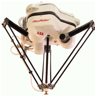
Şekil 1.5 EPFL'nin Delta robotu gerçekleştirilmesi, ABB Flexpicker [2]
