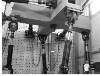
Şekil 1.3 Minnesota Üniversitesinde deprem simülasyonunda kullanılan sarsma masası [1]
