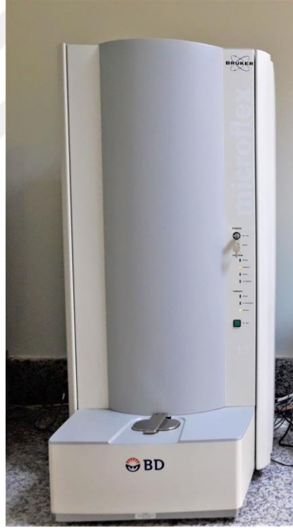
Resim 3.12. İdentifikasyon Cihazı Matriks Yardımlı Lazer İyonizasyon Kütle Spektrometresi, MALDI - TOF MS
