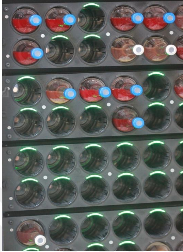
Resim 2.1. Cihaza yerleştirilmiş kan kültür şişeleri ve sinyal renkleri
