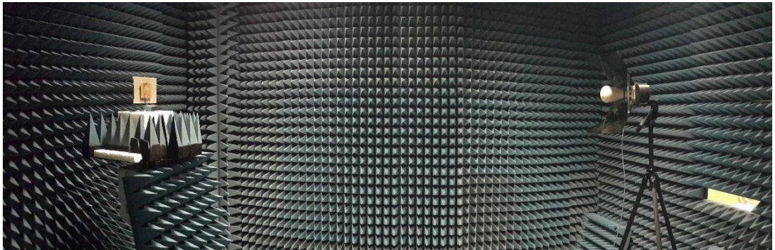
Şekil 4.18. Yansımatsız odada ölçüm düzeneği
