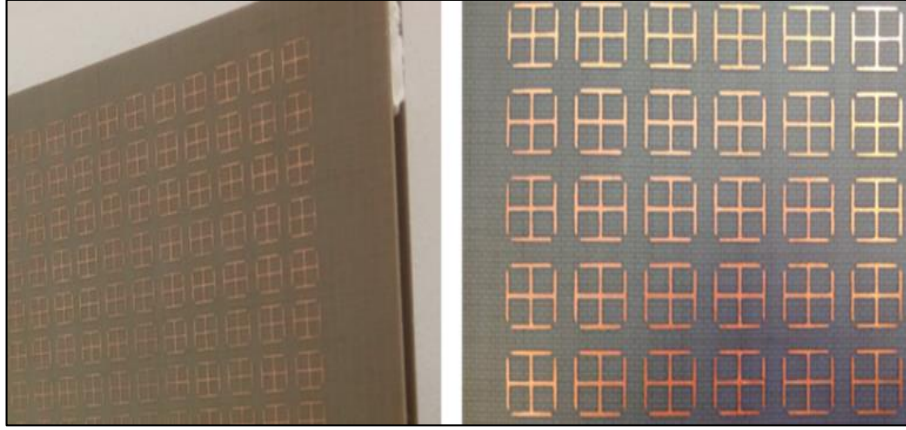
Şekil 2.25. Arlon Diclac 880 üzerinde üretilen iki katlı FSY
