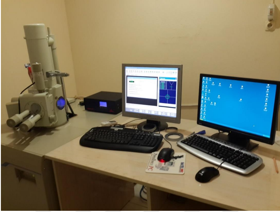
Resim 3.4 : Energy dispersive x-ray ölçümlerinin yapıldığı SEM cihazı
