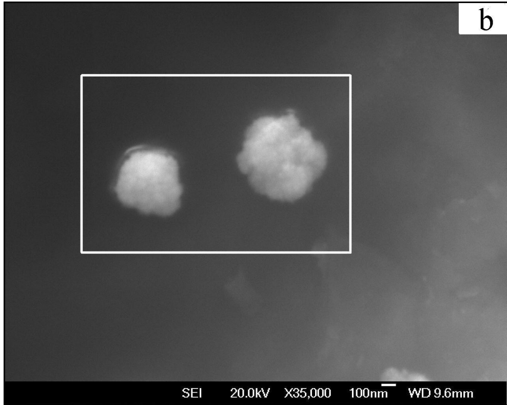
Şekil 4.2 R. mucilaginosa ile modifiye edilen elektrodun x3500 (a) ve x35.000 (b) büyütme ile çekilmiş SEM görüntüleri
