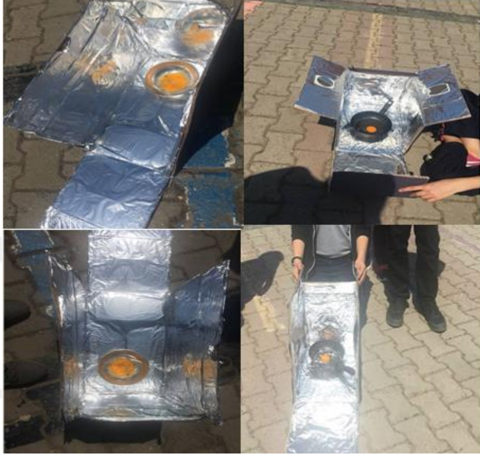
Şekil 2.4. FeTeMM Etkinliği “Güneş Fırını Yapıyoruz” Tasarım Örnekleri
