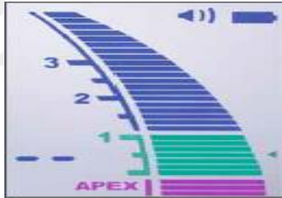
Resim 2.11. Ölçüm aletinin sağ tarafındaki küçük üçgen referans için ayarlanan noktayı gösterir [120].
