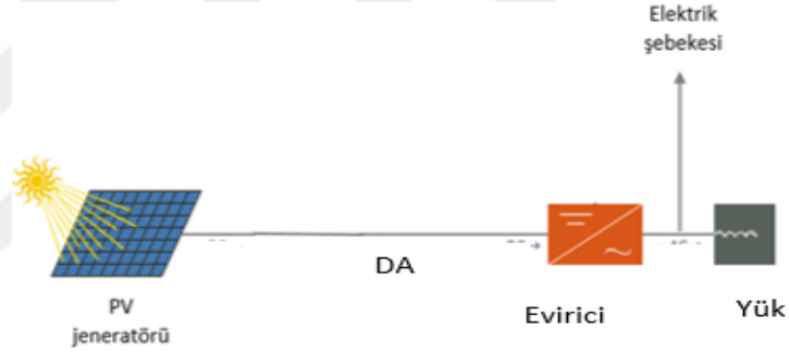
Şekil 1.5. Tipik olarak ihtiyaç duyulan bileşenlerle birlikte şebekeye bağlı FV sistemi gösteren şema
