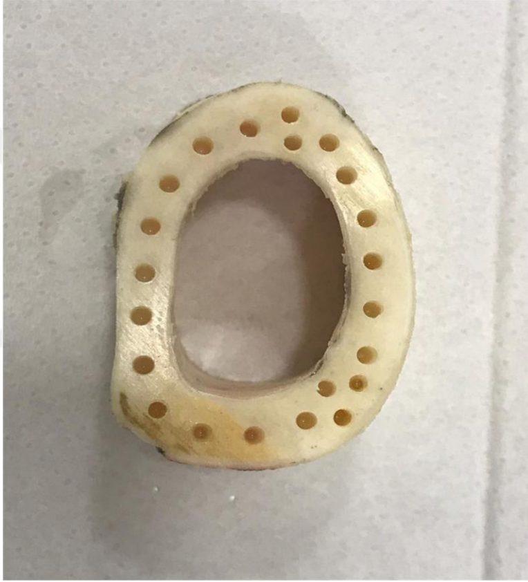
Şekil 3.8. Drillerin yüzey aşındırmasının yapıldığı çalışmada kullanılmayan taze sığır femur kortikal kemiği
