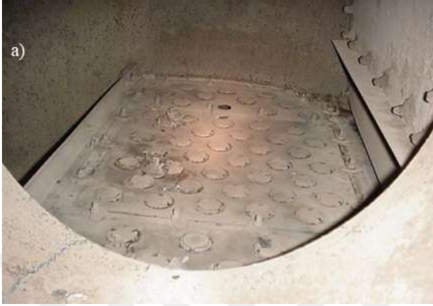
Şekil F.1. Kapaklı tepsi( valve tray)
