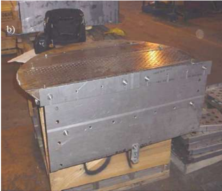
Şekil F.2. Elek şekilli tepsi (Sieve tray)
