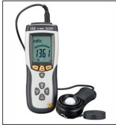
Şekil 3.2. Işık şiddeti ölçen luxmetre
