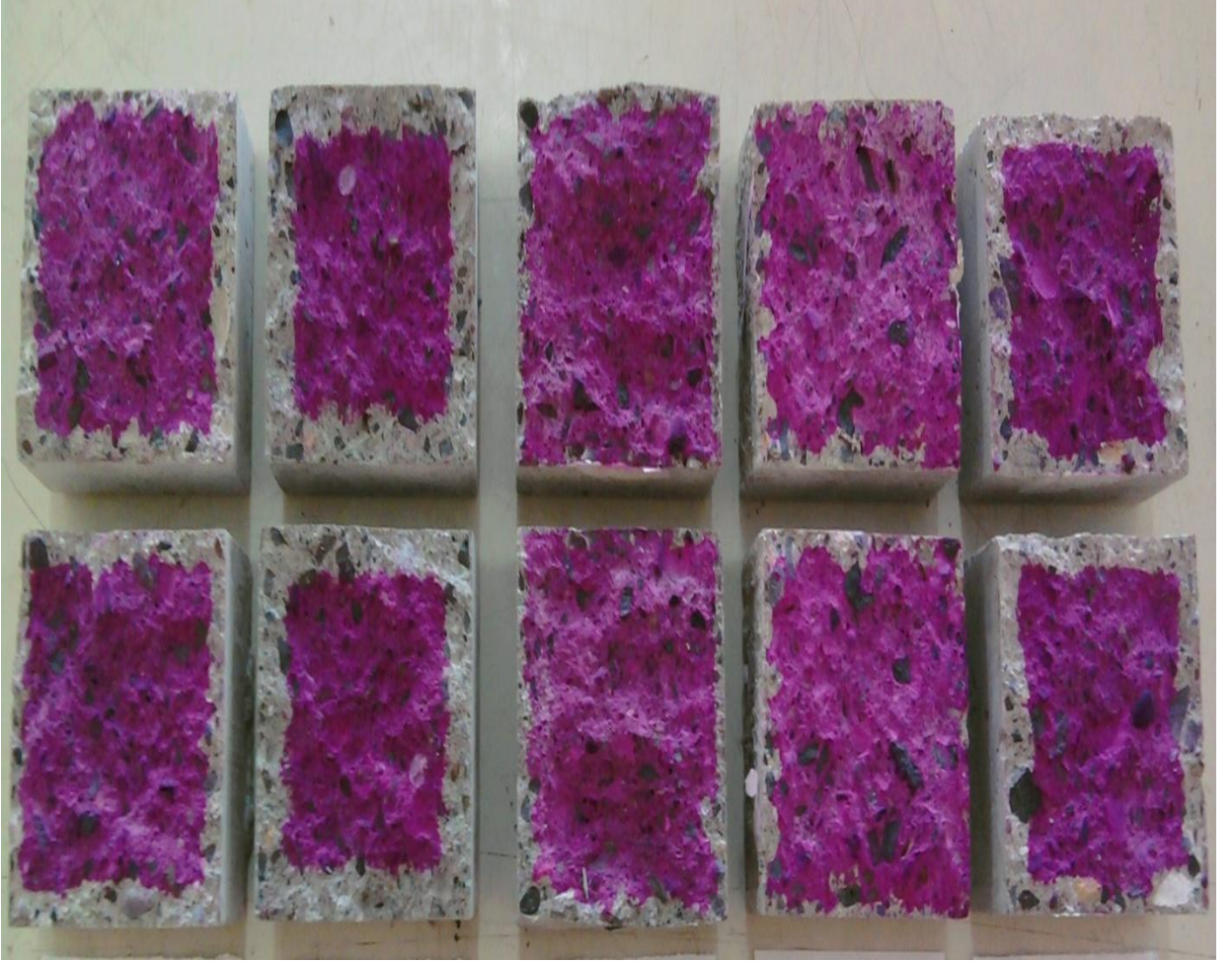
Şekil 5.11 Farklı Zaman Dilimlerine Göre Fenolfitalein Püskürtülen Beton Serilerin Görüntüsü
