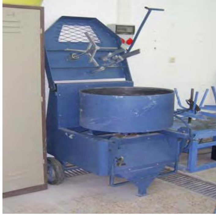
Şekil 4.3. Beton Üretiminde kullanılan beton mikseri
