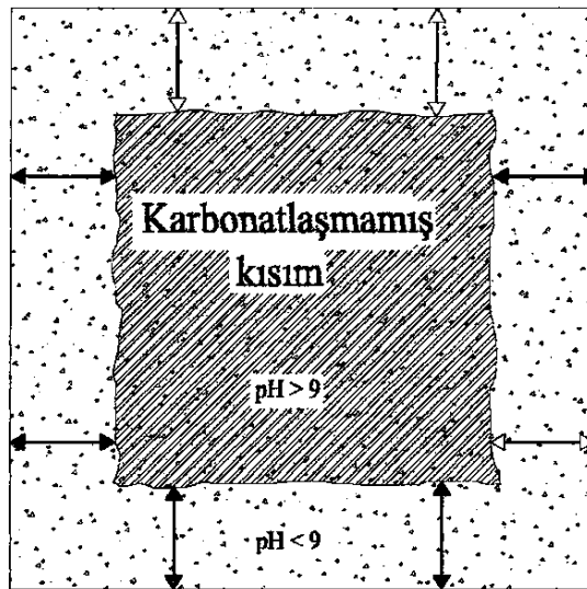
Şekil 3.5. Karbonatlaşma derinliğinin Belirlenmesi [42]
