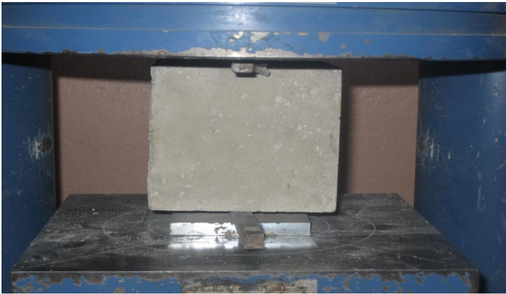
Şekil 5.10. Karbonatlaşma Sonrası Beton Serilerin Bir Aparat Yardımıyla İkiye Bölünmesi
