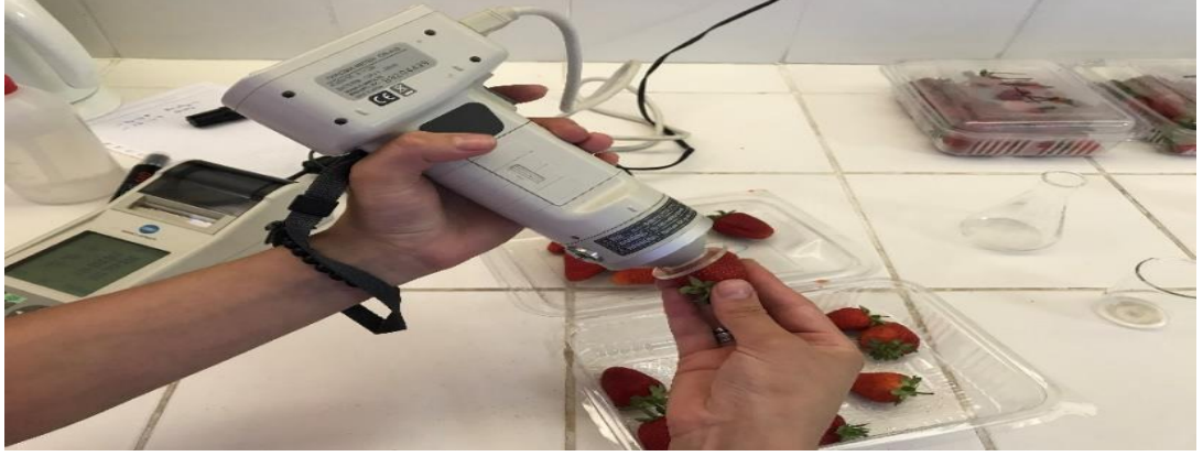
Şekil 2.9. Minolta CR 400 Chroma portatif renk ölçer ile ölçüm
