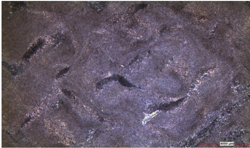
Şekil 5.12. a) 15^{\circ} , b) 60^{\circ} , c) 90^{\circ} partikül çarpma açısı ile aşındırılmış kompozit numunelerin stereo mikroskop görüntüleri (fiber yönlenmesi: +45/-45 , aşındırıcı partikül boyutu: 60 mesh)
