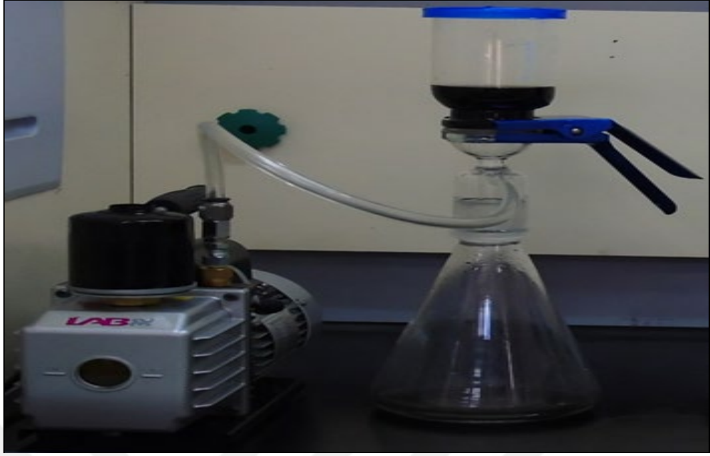
Şekil 3.2. Filtrasyon yöntemi ile GO film üretiminde kullanılan vakum filtrasyon sistemi fotoğrafı
