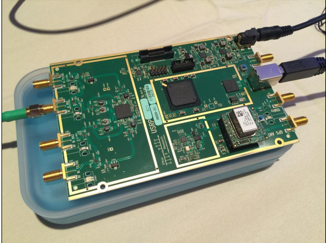
Şekil 4.2. USRP B210 platformu
