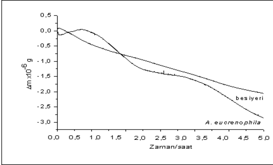
řekil 4.13 Ni-Cu alařımının steril besiyeri ve A. eucrenophila inokle edilmiř besiyeri ortamında 5 saat sreyle ktle kaybı
